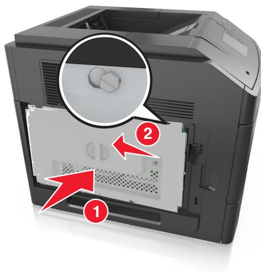
6 Apriete los tornillos del protector de la placa del controlador.
