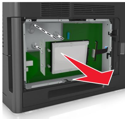
**5** Coloque el disco duro de la impresora a un lado.
