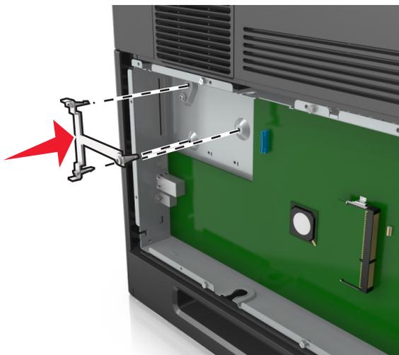
**Nota:** Asegúrese de que el soporte de plástico esté bien encajado y de que esté colocado firmemente en la carcasa de la placa del controlador.
